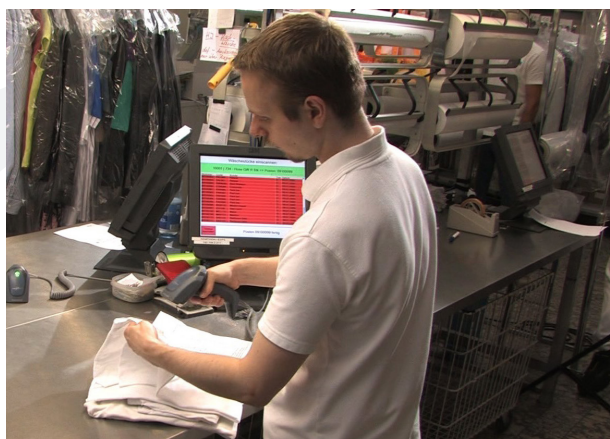
Alle Wäschestücke, die gereinigt werden müssen, sind mit einem festen Nummerncode versehen, der mit Barcodescannern einfach und schnell erfasst wird.
